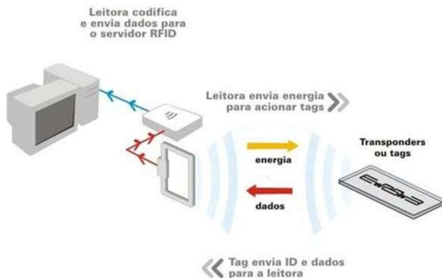
Figura 3 –Esquema Básico de RFID.
