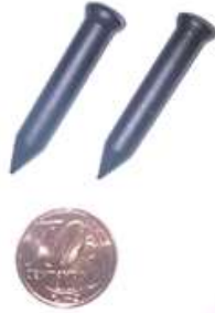
Figura 2 - Pregos RFID para implantar em Árvores.
