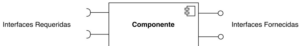
Figura 2.1: Representação UML de um componente.
